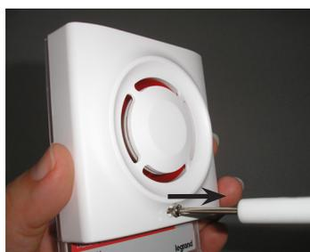
Déclipser la capot du buzzer
