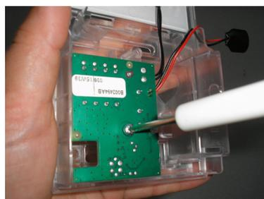
Retirer le circuit puis déconnecter le câble du buzzer
