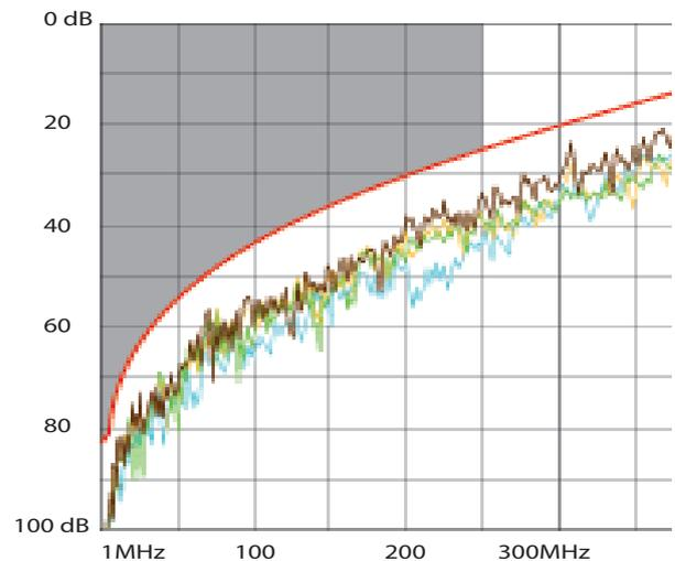
ELFEXT (Equal Level End Crosstalk Attenuation) (Atténuation télé-dia-
