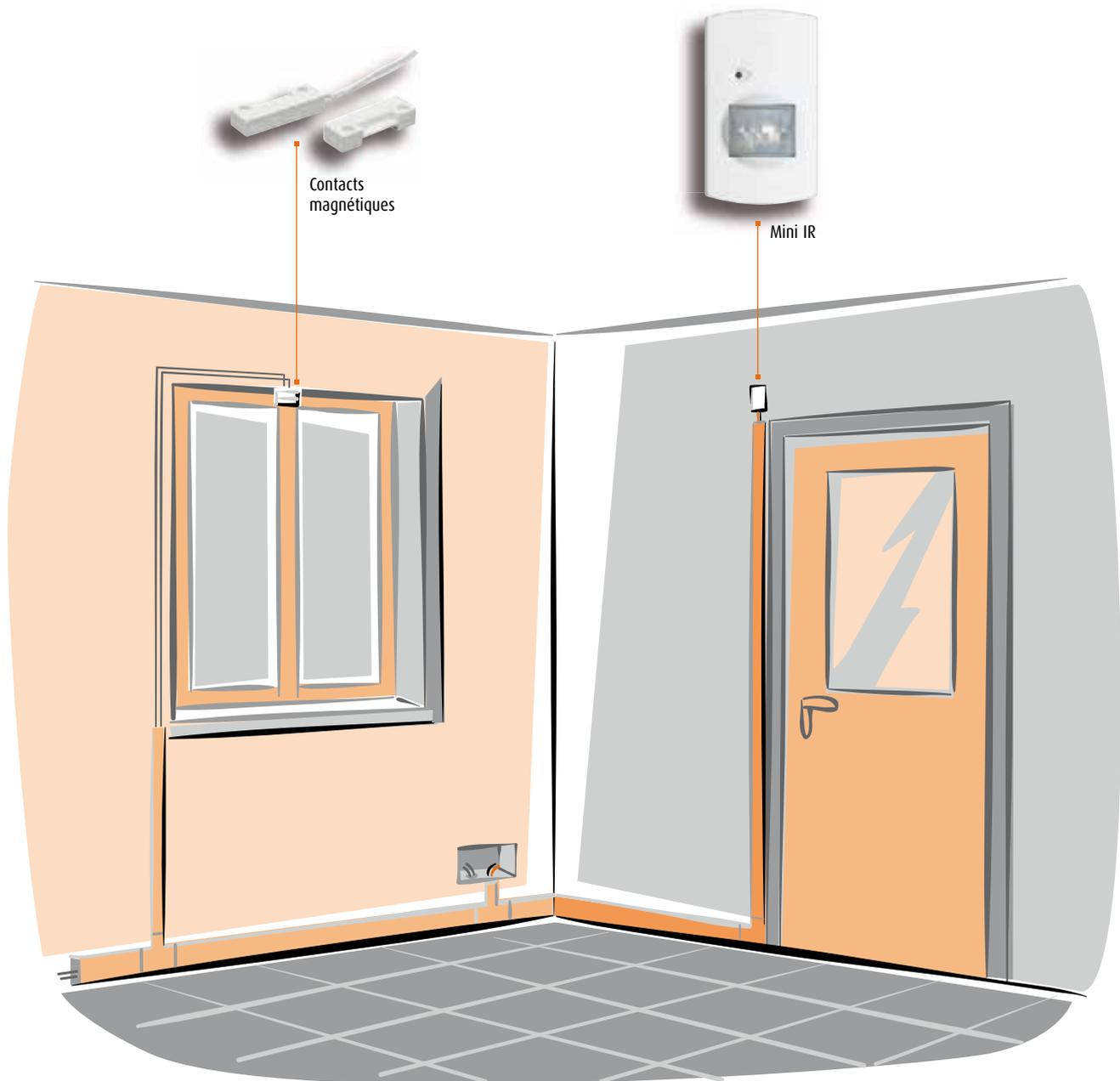
Lors de l'installation des contacts magnétiques, il est conseillé de prévoir une canalisation adéquate en surface jusqu'aux montants des menuiseries. Il faut ensuite faire courir les fils jusqu'au point du bâti où le détecteur est fixé. Les fils des contacts ont une section réduite par conséquent ils ne posent de problèmes lors de la remise en place du montant.
