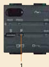
Diriger la **télécommande déjà programmée sur la première installation** vers un dispositif de sectorisation des zones 1÷4 ou un contacteur de la deuxième installation.
