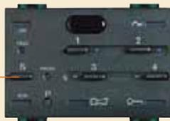
2) Appuyer sur le bouton poussoir d'une des télécommandes ; la led TEST s'allume, à présent on peut relâcher la touche S.
