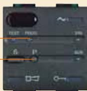
Adosser la lentille de transmission (1) de la télécommande à la lentille réceptrice (2) de la centrale de façon à la maintenir parfaitement dans l'axe (couvrir la lentille en cas de gênes sur l'infrarouge dues, par exemple, à la lumière directe de lampes ou de spots).
