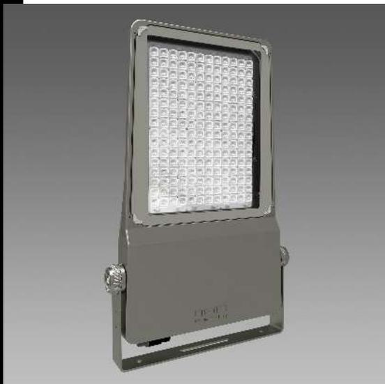
Corps : aluminium moulé sous pression Alliage EN-AB 47100, avec une très petite surface d'exposition au vent. Ailettes de refroidissement incorporées dans le ca-pot. Après retrait du capot, il est possible d'accéder au boîtier des accessoires électriques.
